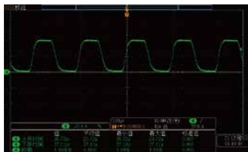
IT8906A-1200-240 5kHz動態拉載0A-50A
