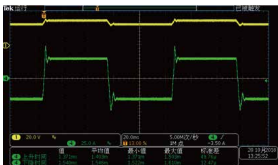
啟動浪湧電流超電流量程，高速建立電壓 CV優先
