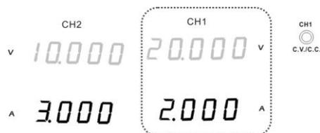
Master (CH1) voltage level: 讀 CH1 表頭顯示輸出電壓。在以上情況，20.0V。
