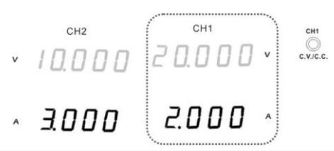
電壓值：讀 CH1 表頭顯示輸出電壓值。在以上情況，20.0V。
