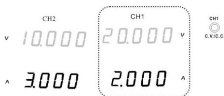
電壓值：讀 CH1 電壓表頭的 2 倍。在以上情況，實際輸出是  $20.0 \times 2 = 40.0V$
